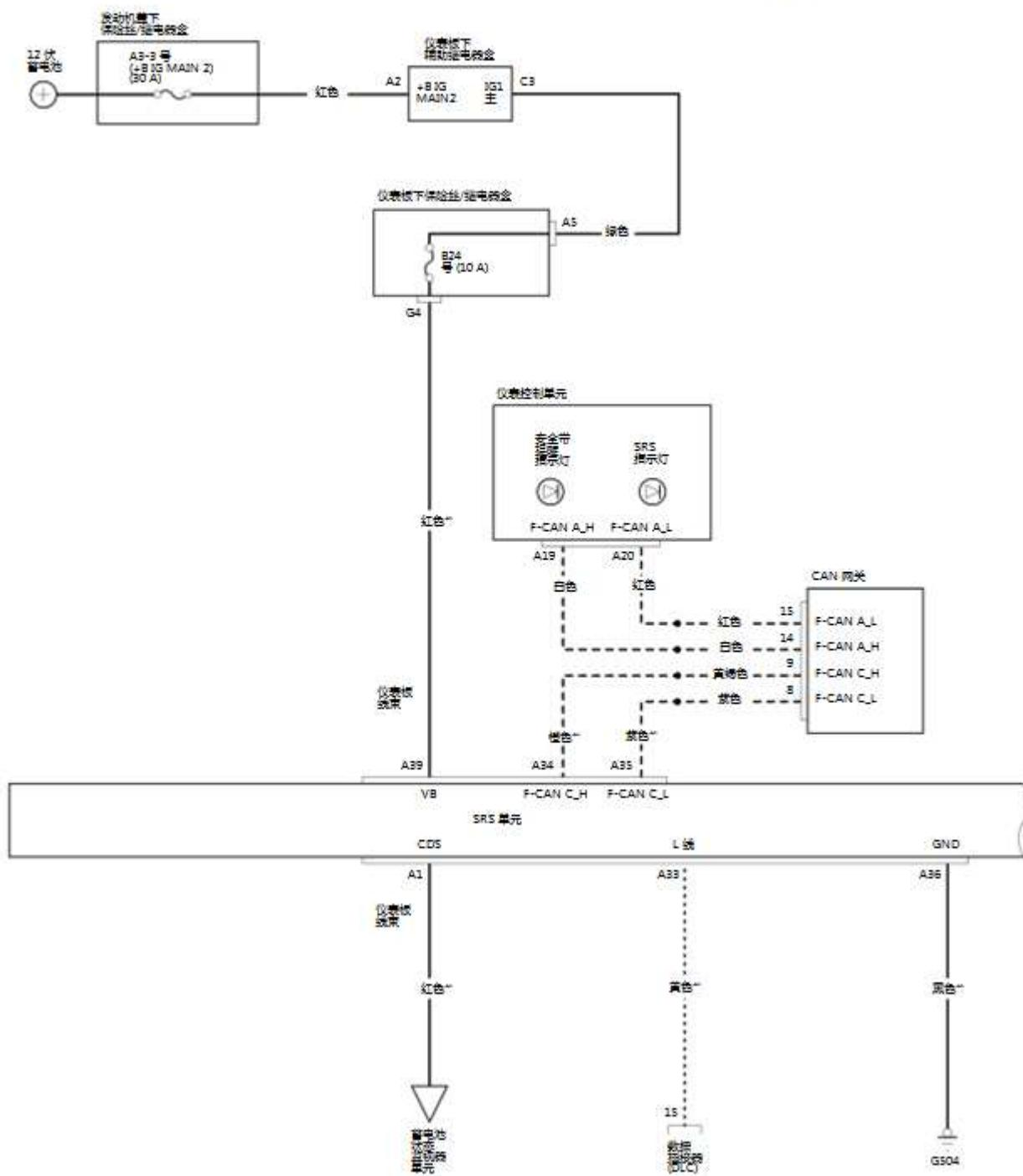
\*1: 可替换 SRS 电阻的导线颜色
